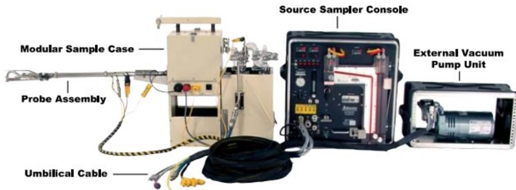
Gambar 3. Alat Sampling Isokinetik
